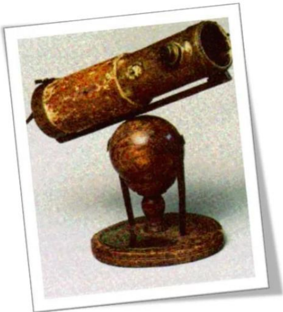
Figura 15: Telescópio Newtoniano. Por utilizar espelhos, evitamos a aberração cromática. Como espelhos são mais fáceis de serem confeccionados, tais telescópios possuem maior abertura, permitindo maior luminosidade na imagem final.
