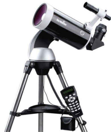
Figura 17: Telescópio Cassegrain moderno. Ele é capaz de acompanhar, por exemplo, uma estrela automaticamente.
